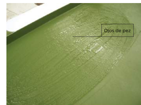
Fig 2. Previo a frotar se pueden formar ojos de pez debido a residuos en superficie procedentes de desmoldantes.
