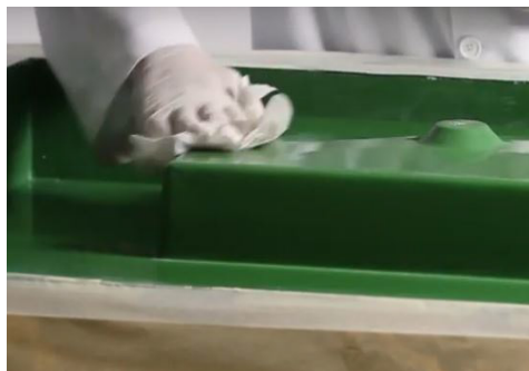
Figura 1. Retirar contaminantes con un trapo o trozo de papel limpio.
