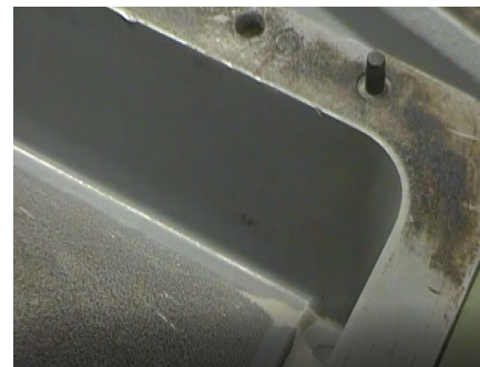
Figura 1. Molde sucio con incrustaciones de material del proceso productivo.
